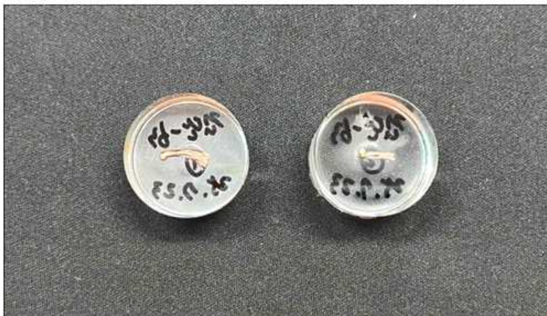
【사진 5】 시료 채취부분(좌) 및 금속조직 분석용 시료(우) 제작
